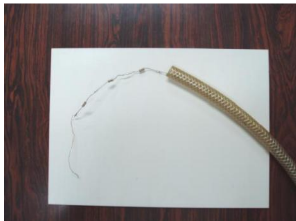
Fig.04 – Associação de resistores em série recobertos por uma mangueira
