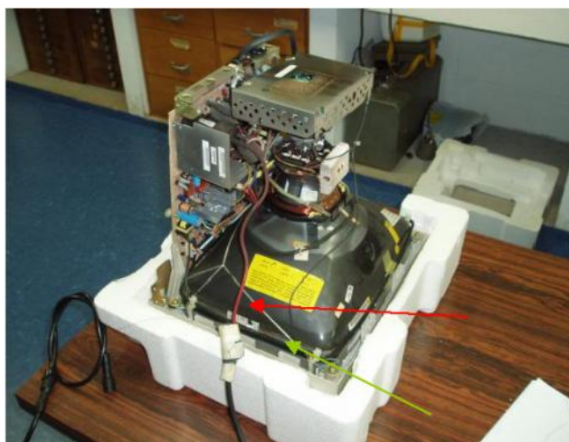
Fig.03 – Locais para conexão de cabos no micro. A seta vermelha indica o anodo e a verde o catodo.
