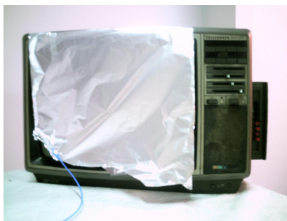
Figura 2: Folha de papel alumínio colocada sobre um visor de televisor antigo e conectada por um fio a uma das latas. A folha não encosta na tela.
