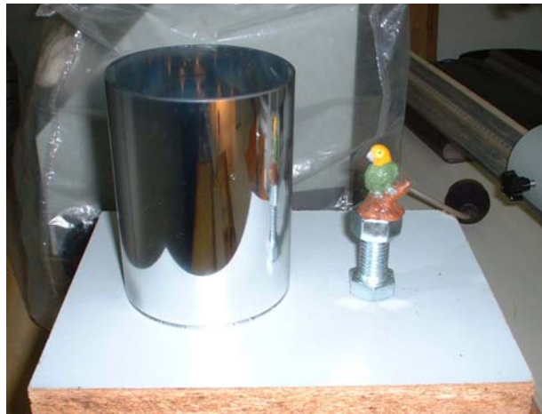
Fig. 8 – Tubo de vidro metalizado tendo a seu lado miniatura sobre plataforma (parafuso ajustável) a ser inserida em seu interior.
