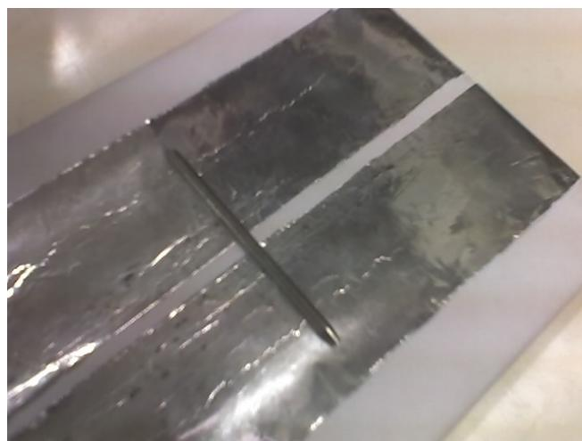
Figura 6: O movimento foi observado em uma haste metálica possuindo uma pequena velocidade inicial, sem campo magnético externo.
