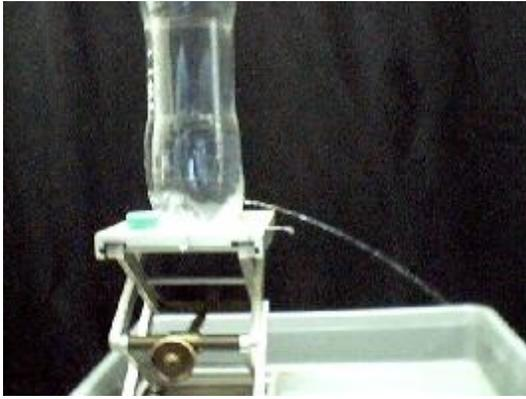
Fig 9: Trajetória parabólica da água
