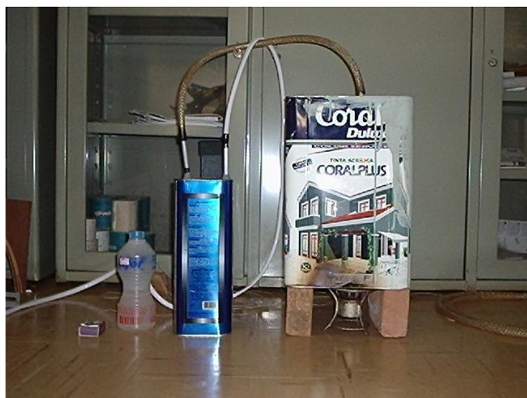
Fig. 4 – Sistema de aquecimento do ar e reservatório de água
