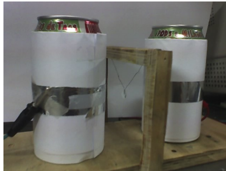
Figura 5: Pêndulo plano em formato circular feito com uma folha de papel alumínio.
