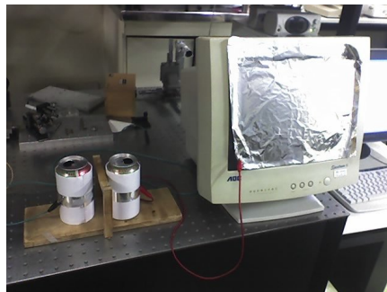
Figura 4: Montagem experimental utilizando o monitor, as duas latas de alumínio, folhas de papel alumínio e um pequeno suporte de madeira.
