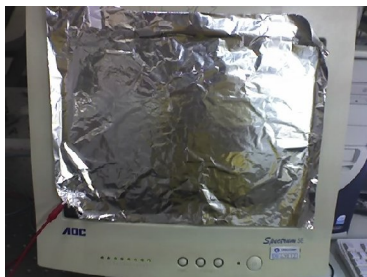
Figura 3: Folha de papel alumínio colocada sobre monitor e conectada por um fio a uma das latas.
