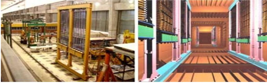
Fig 5: ADS em um laboratório e instalados na viga caixão da ponte rio-Niterói.
