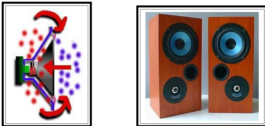
Figura A-2 – Troca de ar na parte posterior e anterior de um alto-falante (à esquerda) e detalhe de duas caixas de som com três alto-falantes cada (à direita).
