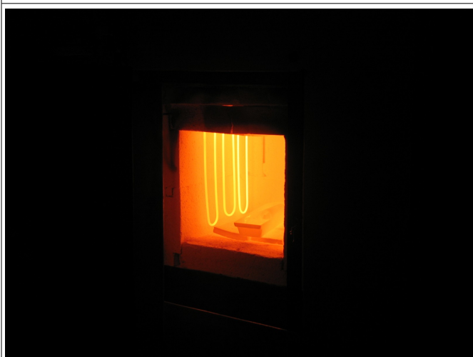
Fig.5: Amostra dentro do forno do DFA a 500°C
