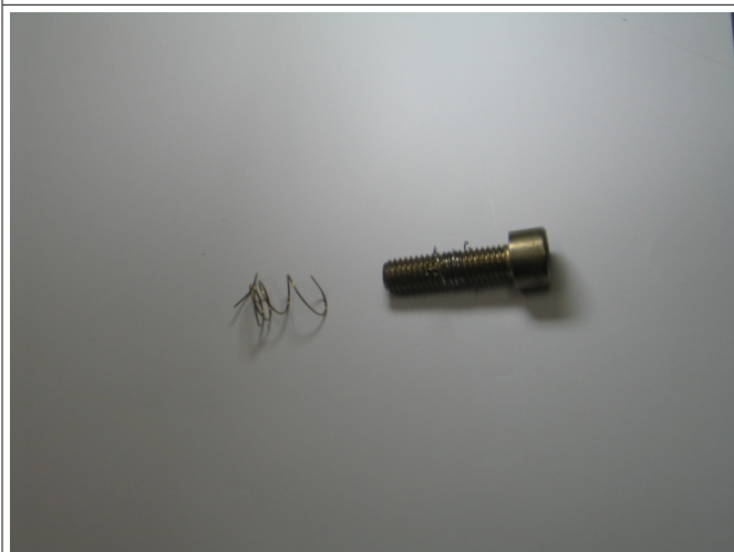
Fig.3: Molde de mola e arco transformado em mola permanentemente
