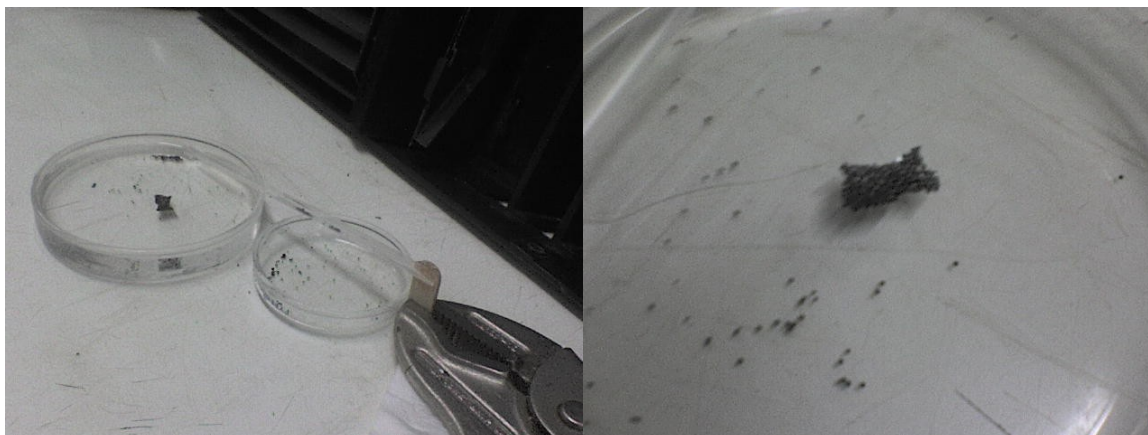
Figura 2: Primeiros resultados da formação do tapete de esferas na superfície da água, sem campo aplicado. À direita, ampliação do primeiro tapete formado. Vê-se no fundo do pirex algumas esferas que romperam a tensão superficial da água e afundaram.
