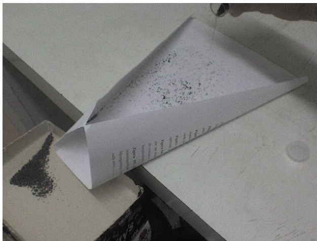
Figura 3: Procedimento usado para selecionar as esferas mais perfeitas, eliminando imperfeições, óxidos e impurezas.
