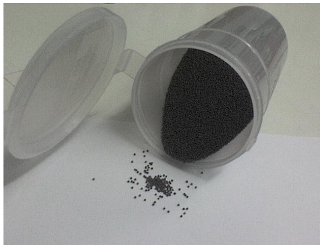
Figura 1: Esferas de aço-carbono utilizadas, de aproximadamente 0,5 mm de diâmetro.
