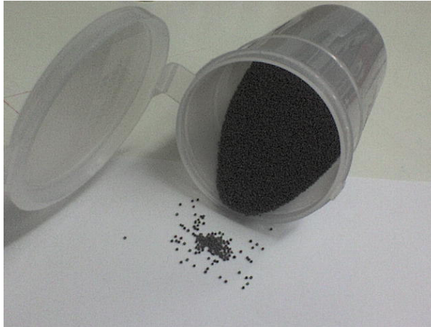
Figura 2: Esferas de aço-carbono utilizadas, de aproximadamente 0,5 mm de diâmetro.
