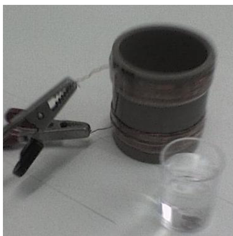
Figura 7: Bobina de Helmholtz e recipiente plástico com água, onde são colocadas as esferas
