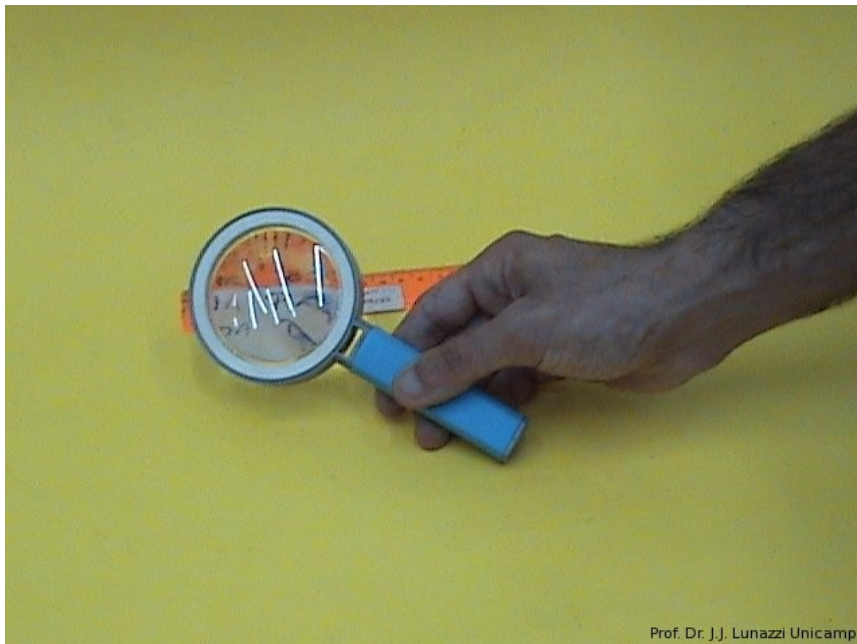
Fig. 6.2.1 Lupa (lente convergente).
