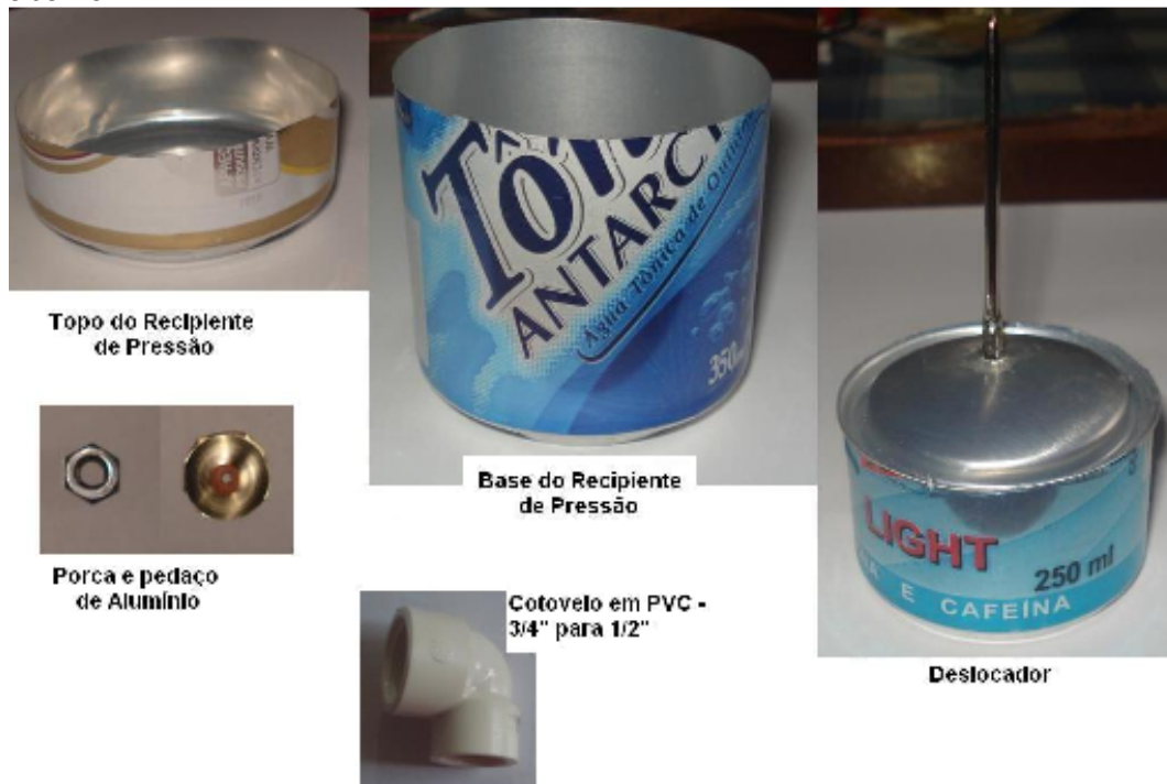
Figura 2 – Topo e Base do recipiente de pressão, Deslocador, Porca, pedaço de Alumínio, Cotovelo em PVC.
