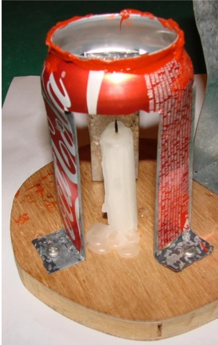
Figura 2 – Base de sustentação do Motor Stirling
