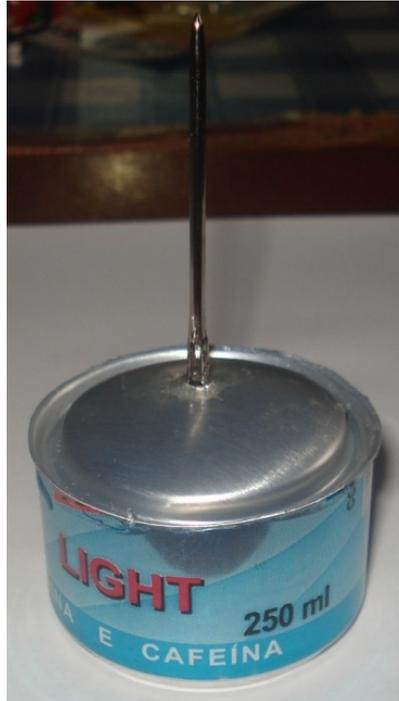
Figura 4 – Displacer ou Deslocador
