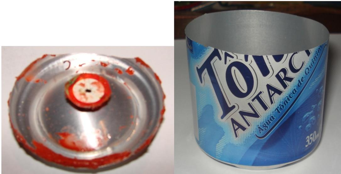
Figura 3 – Topo do recipiente com a porca e o pedaço de aço e Base do recipiente
