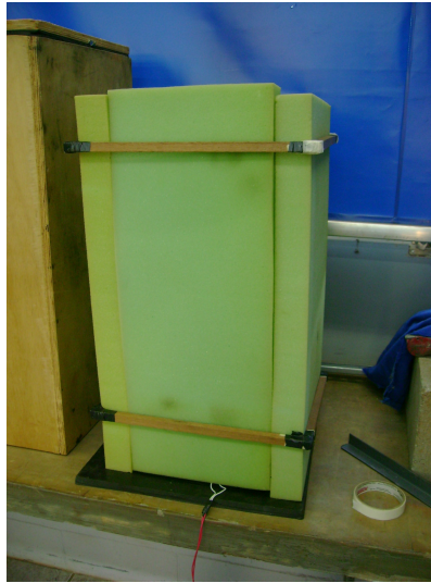
Figura 4(b) – Medições para a campainha enclausurada com espuma
