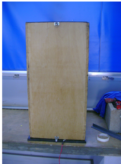
Figura 4(a) – Medições para a campainha enclausurada com madeira
