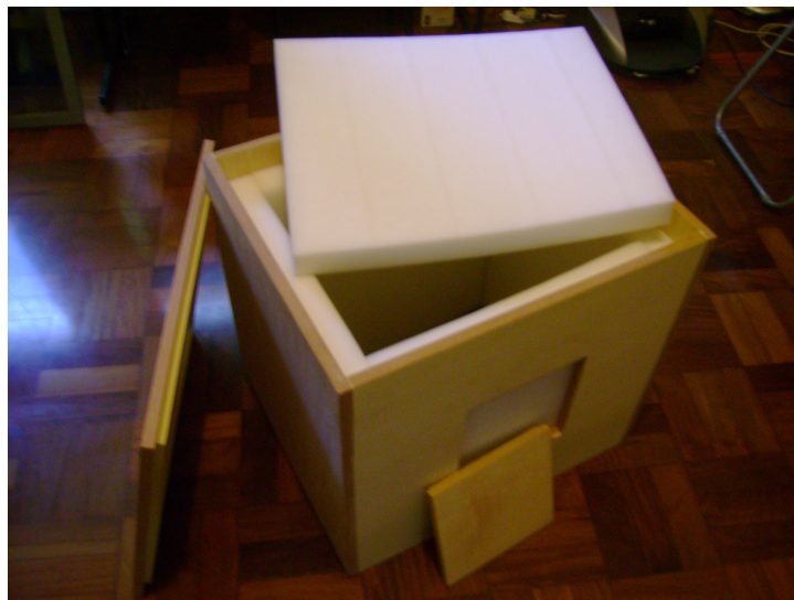
Figura 6 – Fechamentos de madeira com revestimento de espuma
