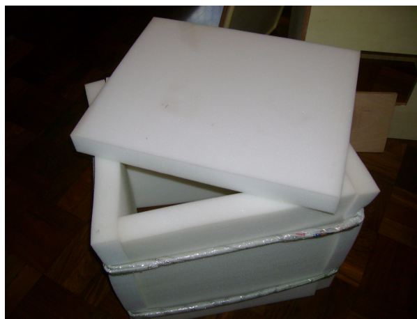
Figura 7 – Fechamentos de espuma com armação de jornal
