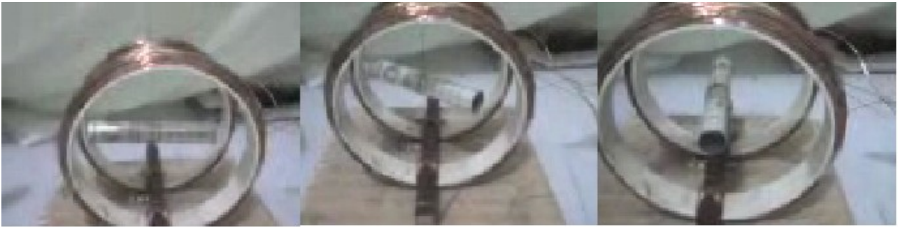
Figura 15 – Objeto cilíndrico feito de alumínio imerso em um campo magnético uniforme.
