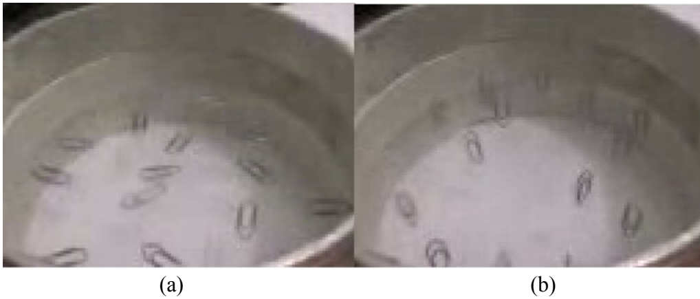
Figura 19 – (a)clipes deitados, pode ocorrer com o campo ligado ou desligado (b)clipes em pé, só ocorre com o campo ligado.
