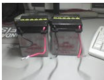
Figura 22 – Baterias de 12 volts
