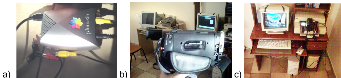
Figura 1 – (a) Dispositivo USB de conversão da Pinnacle, (b) Filmadora Sony, (c) dispositivos montados no computador.
