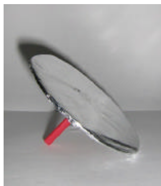
Figura 5: Eletróforo. O disco é condutor e o cabo é isolante.
