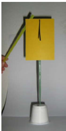
Figura 3: Eletroscópio sendo carregado por contato.
