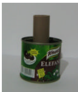
Figura 8: Eletróforo construído com lata de extrato de tomate e cano de PVC.
