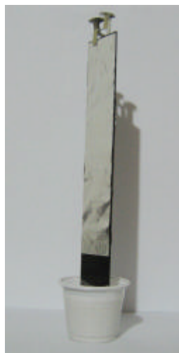
Figura 6: Garrafa de Leiden construída com régua.
