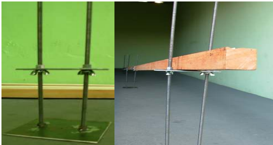
Figura 05: Suporte para a rampa.
