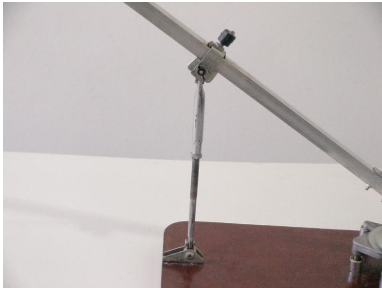
Figura 04: Dispositivo para diminuir trepidação da haste
