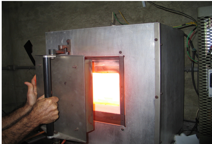
Fig.10: Forno de alta temperatura do DFA a 1300°C.
