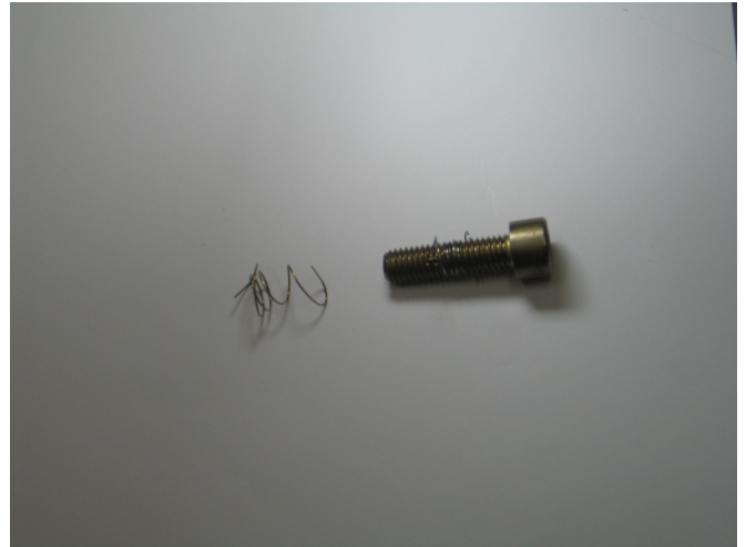
Fig.15: Molde de mola e fio moldado.
