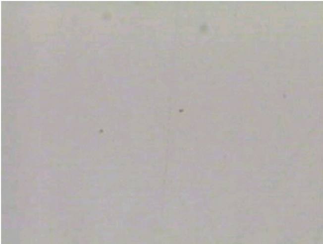
Fig.7 : Metalografia da amostra 3 antes do ataque químico, onde vemos uma grande uniformidade e assim, apenas uma fase .
