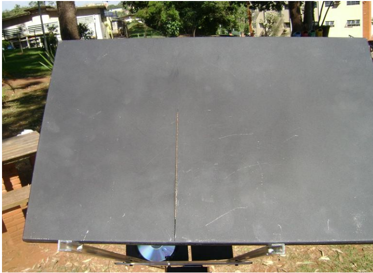
Figura 2.2.1 – Placa metálica com fenda vista.
