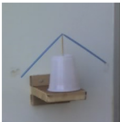
Figura 6. O experimento de indução eletrostática por atrito.
