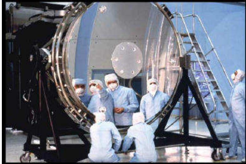
Figura 18: Inspeção pré-vôo do espelho primário do Hubble. Reparem no espelho côncavo dentro do telescópio.
