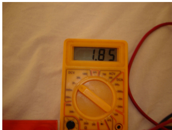
Figura 2: quantidade de tensão medida quando o lêm verde acende.
