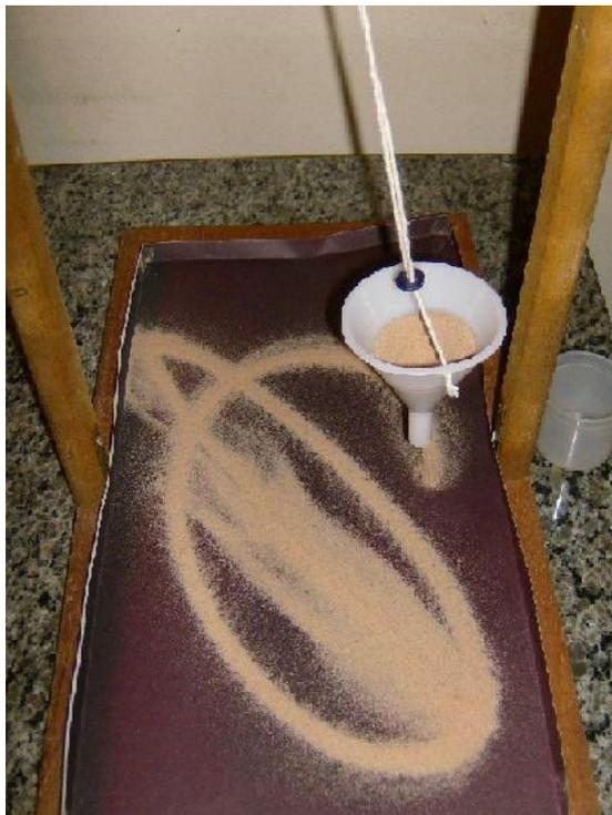
**Figura 05:** Pêndulo em Funcionamento
