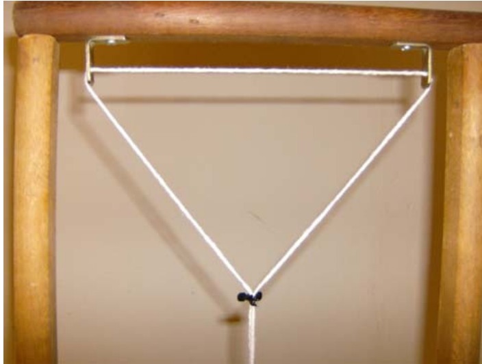
Figura 02: Visão do ponto de bifurcação do pêndulo
