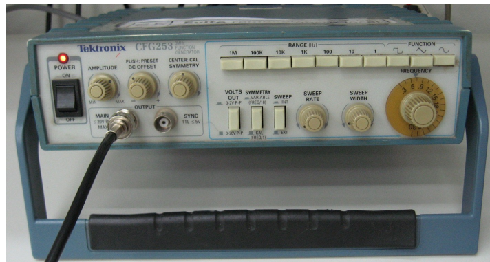
Gerador de sinais usado como fonte para os Leds
