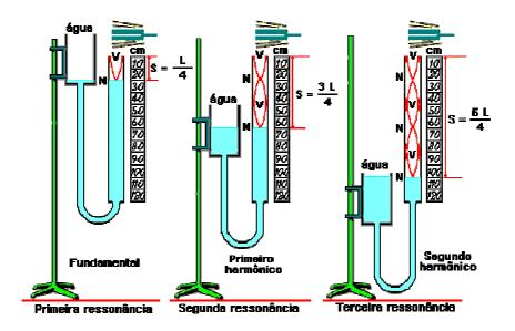
A coluna de água no ramo esquerdo do tubo garante a não entrada de ar, vedando a outra extremidade. A coluna de água do ramo
