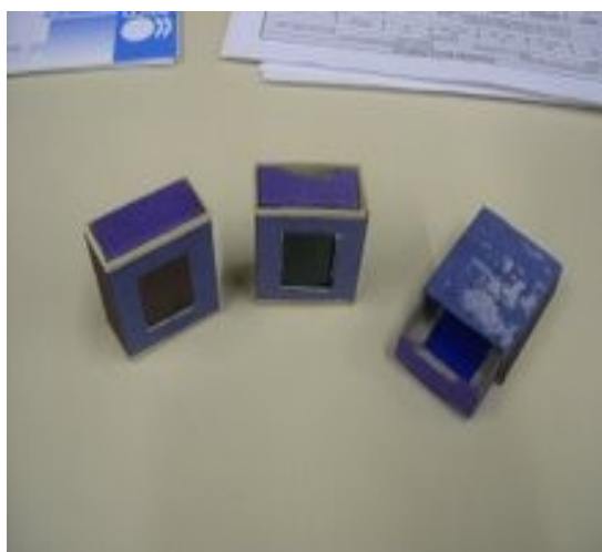
Figura 4: Filtros com recortes por onde passará o LDR.
