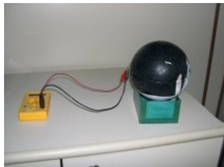
Figuras 9 e 10: LDR na bola de isopor e conexões com multímetro
