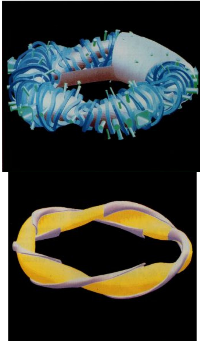
Projeto W7 - X, Stellarator do tipo HELIAS (ASS. EURATOM - IPP, GARCHING e GREIFSWALD - D). À esquerda, bobinas toroidais e criostato. À direita, Plasma e placas do divisor.
