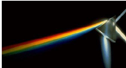
Fig. 5: Um prisma triangular separa a luz branca nas suas cores componentes. Onde se observa que a dispersão cromática ocorre na primeira interface e é acentuada na segunda.
