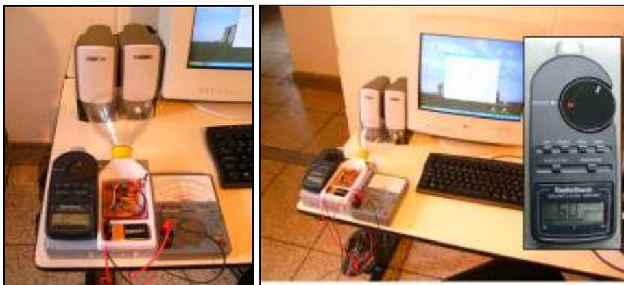
**Figura 6.** Fotos da calibração do medidor experimental de níveis sonoros. No detalhe à direita podemos ver o medidor de níveis sonoros da RadioShack<sup>®</sup>.
