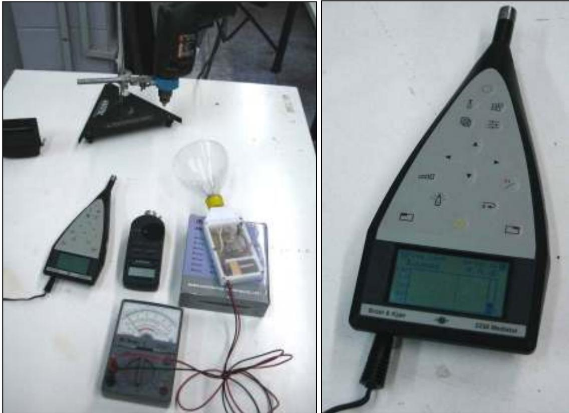
**Figura 8.** Esquerda: Calibração do medidor experimental de níveis sonoros com o medidor profissional 2238 Mediator da Brüel & Kær® utilizando uma furadeira elétrica como fonte sonora. Direita: Detalhe do medidor profissional usado.
