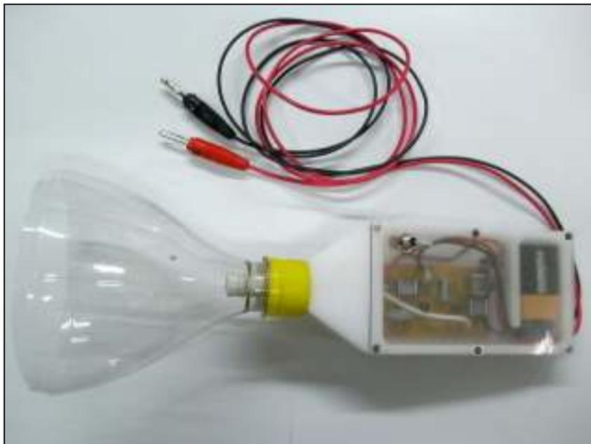
**Figura 7.** Medidor experimental de níveis sonoros pronto para ser usado.
