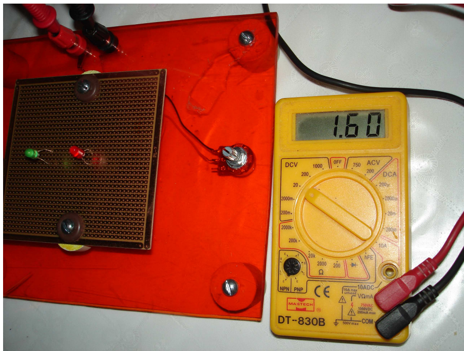
Figura 4: Valor da ddp (tensão) para acender o led vermelho.
