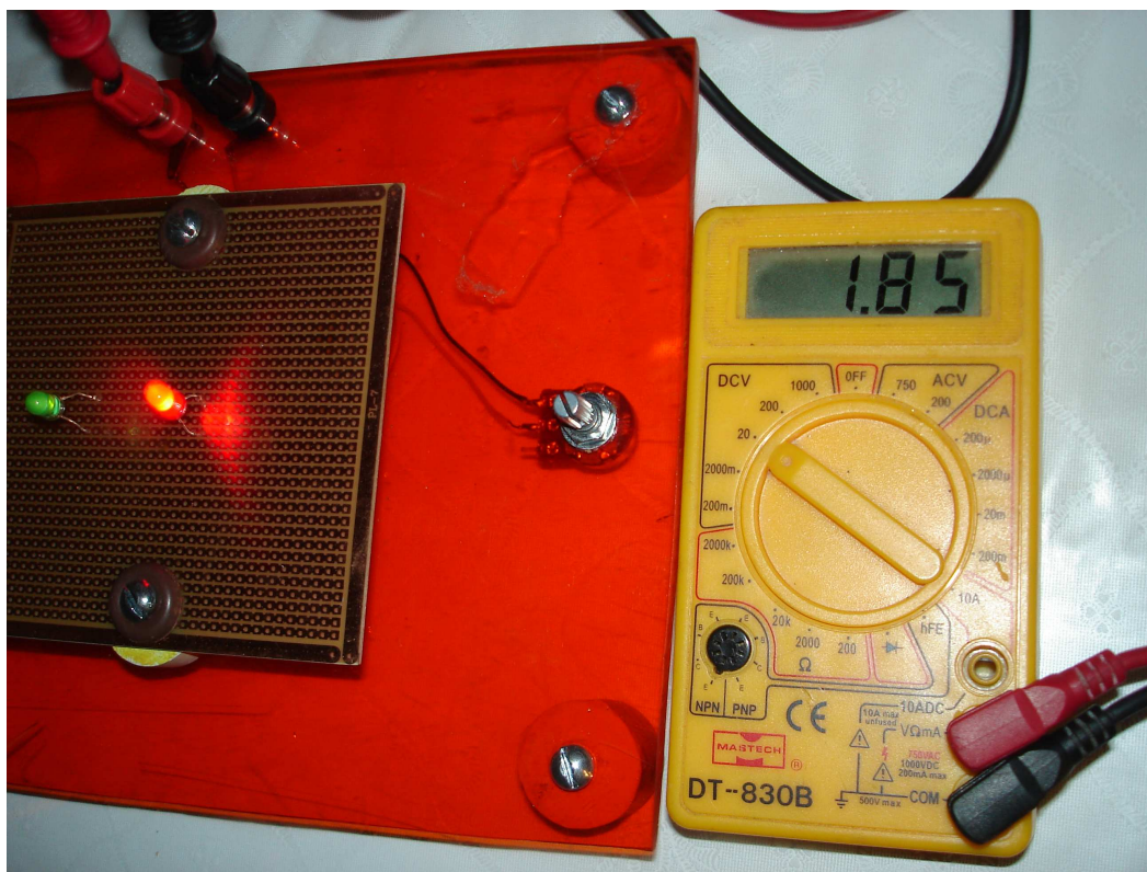
Figura 5: Valor da ddp (tensão) para acender o led verde.
