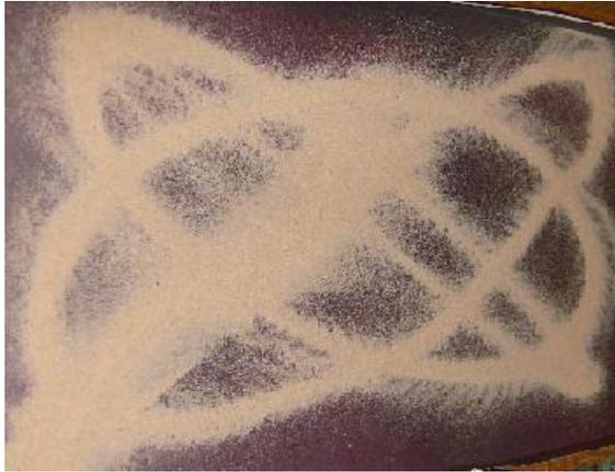
**Figura 06:** Exemplo de Figura de Lissajous formada pela trajetória do pêndulo
