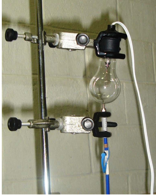
Figura 09 – Montagem experimental para medir a temperatura da lâmpada. Acima a lâmpada incandescente e abaixo a saída da fibra ótica dos espectrômetros.
