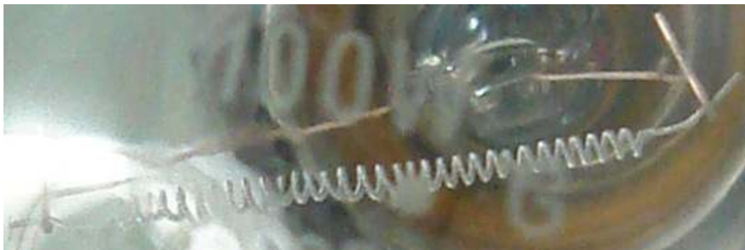
Figura 08 – Filamento da lâmpada desligada. É possível notar que o filamento se curva devido efeito de dilatação térmica.
