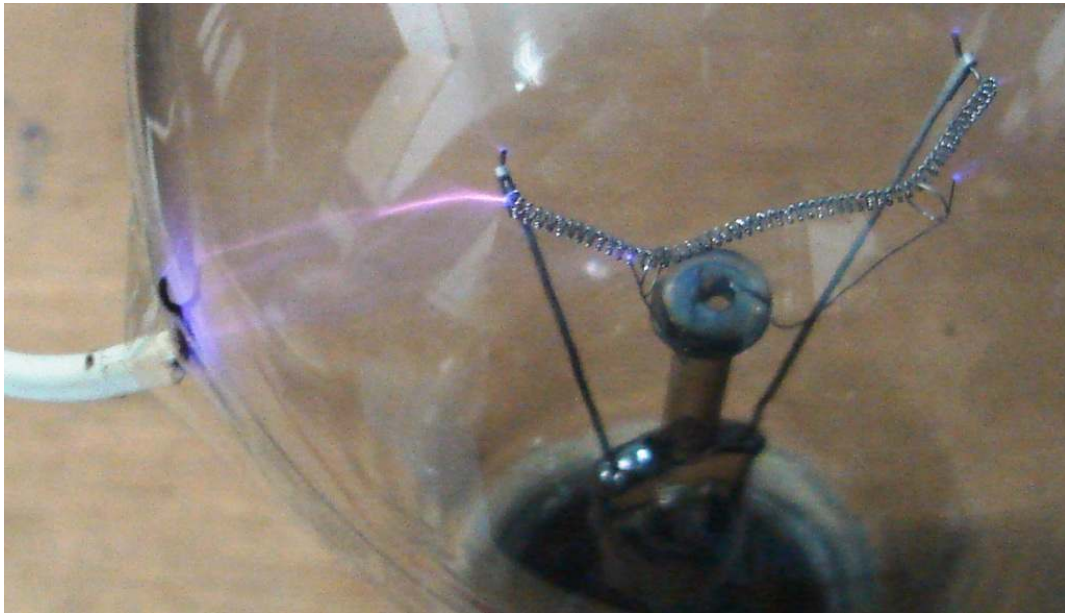
Figura C3 Arco formado no filamento da lâmpada.
