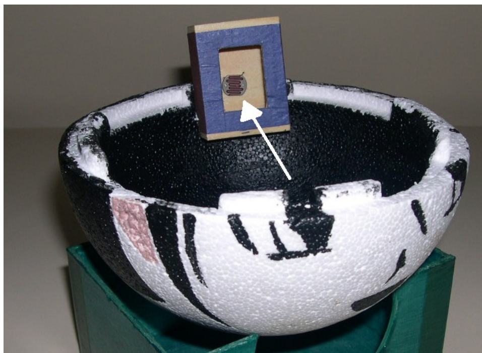
Figura 8: Metade da bola de isopor com sensor e “olho” recortado
