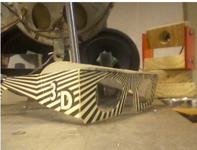
Vista desde a posição de saída dos feixes: óculos polarizadores, atrás os três altifalantes posicionados e, a direita, suporte com ajuste angular para laser.
