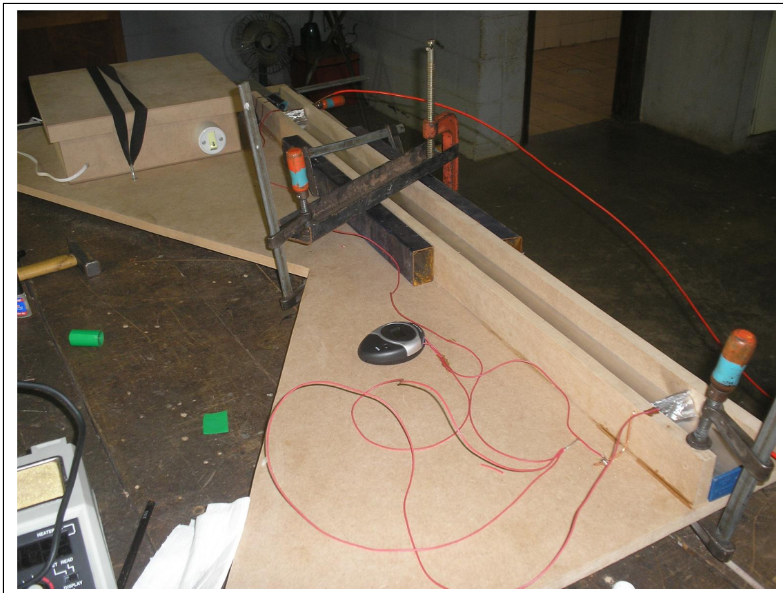
Fig. 8 – Experimento já completo. Alguns grampos ainda prendem as peças de madeira para que não se movam durante a secagem.
