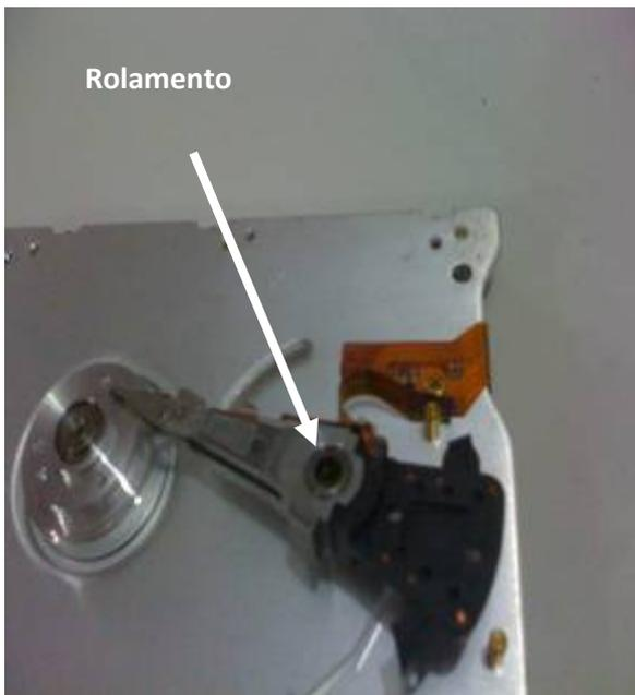
Foto 6: Cabeçote de HD como base para o oscilador
