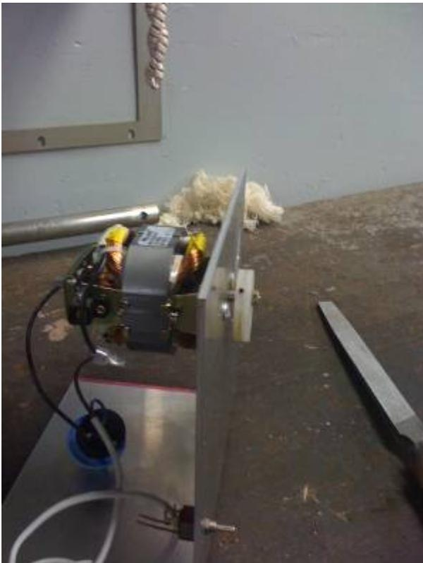
Foto 1: Motor no suporte e disco excêntrico.
