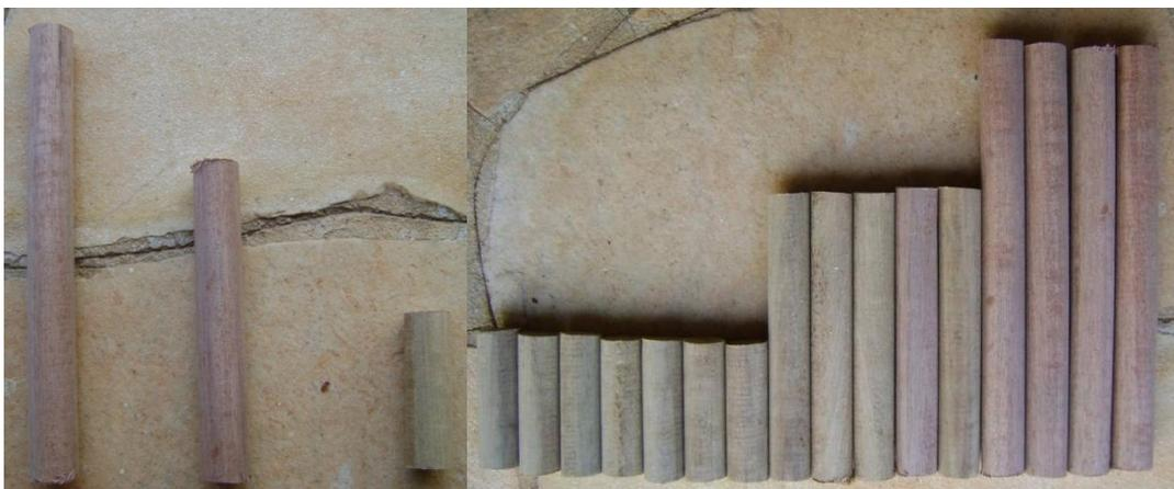
Figura 6: Fotos dos cilindros de comprimentos 7,5cm, 15cm e 22,5cm.
