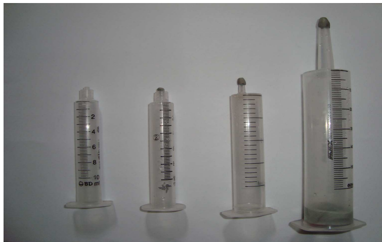
Figura (8) – Visualização dos diferentes relógios de água utilizados para a nova proposta
