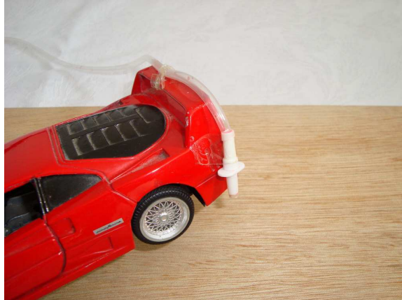
Figura (20) – Montagem do equipo(conta-gotas) acoplado ao carrinho
