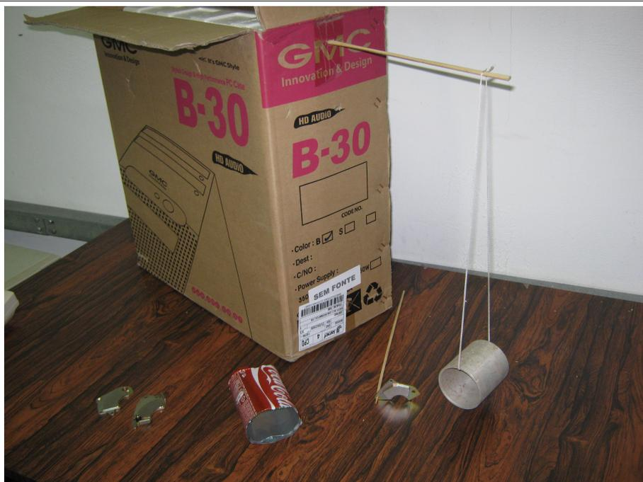
Figura 5: Aparato experimental final: cilindro de alumínio, ímã e caixa de papelão com um espeto como suporte.
