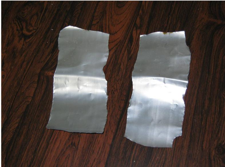
Figura 3: Tentativa de unir duas latas abertas para obter um cilindro de alumínio com o dobro do perímetro de uma lata.
