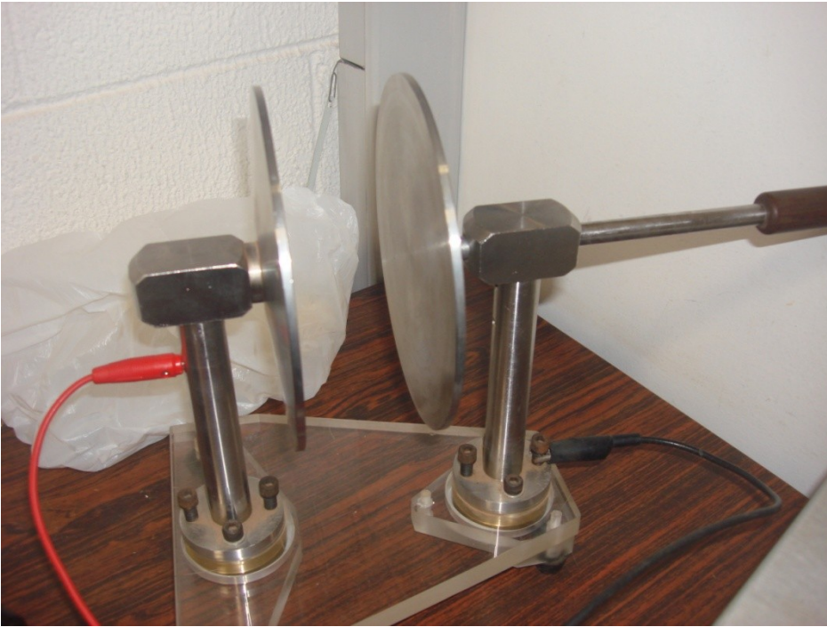
Fig 6 e 7: Capacitor variável fechado e aberto respectivamente.
