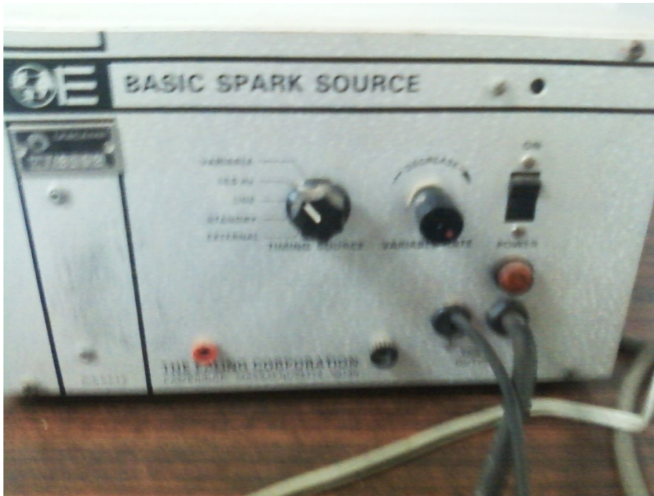
Fig 3: Faiscador sugerido para substituição do circuito oscilador
