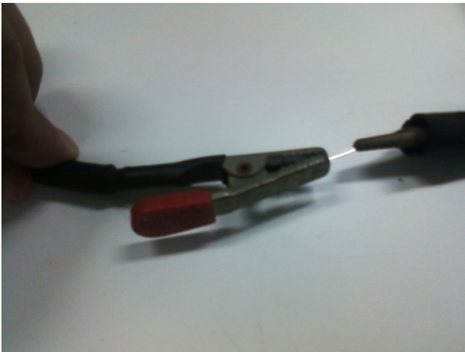
Fig 4: Faisca produzida pelo faiscador.
