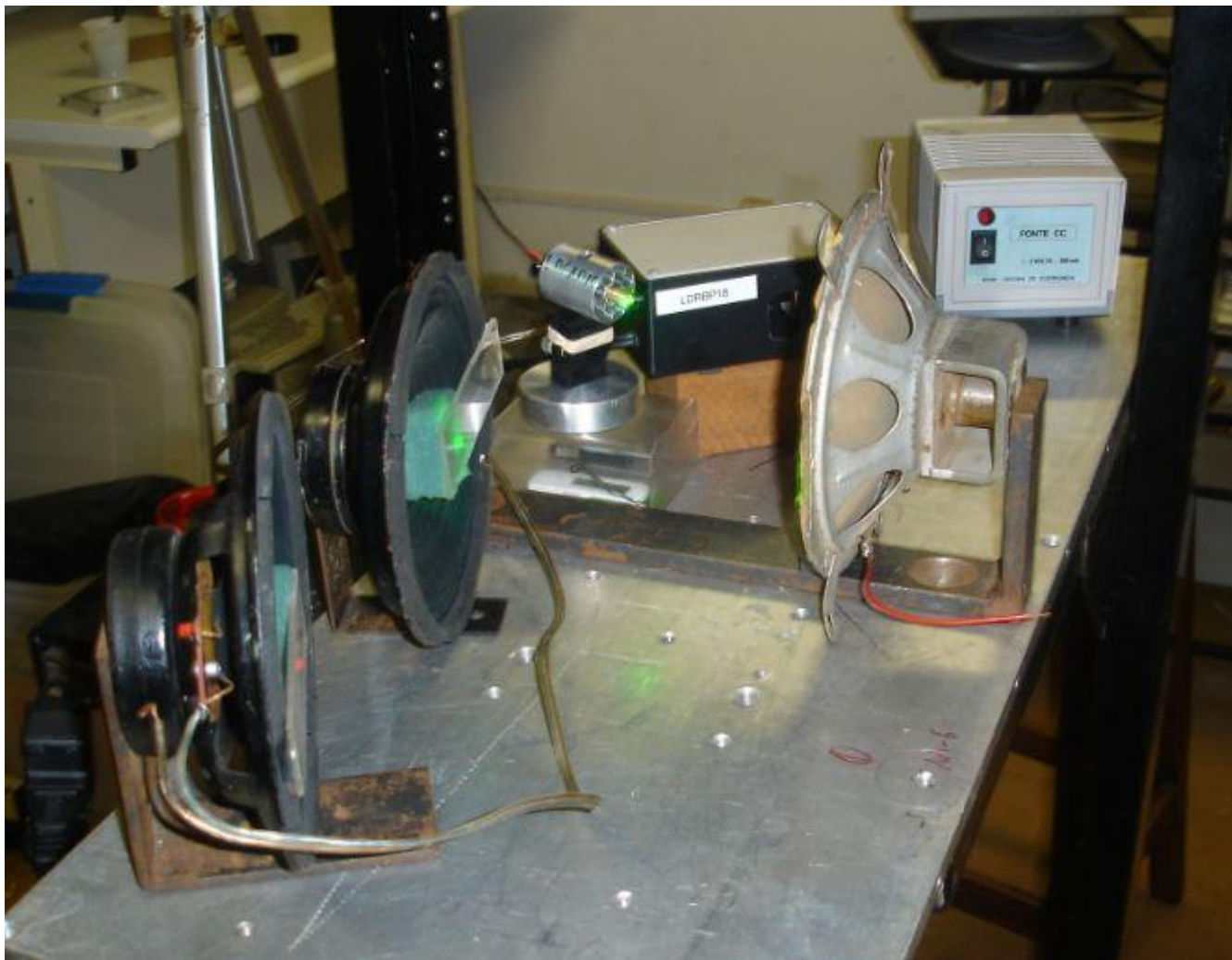
Figura 11 - Nova disposição dos componentes. Desta forma, os lasers ficariam de um lado, enquanto os falantes do outro lado, e desta forma, poderíamos deixar os espelhos todos à mesma altura.
