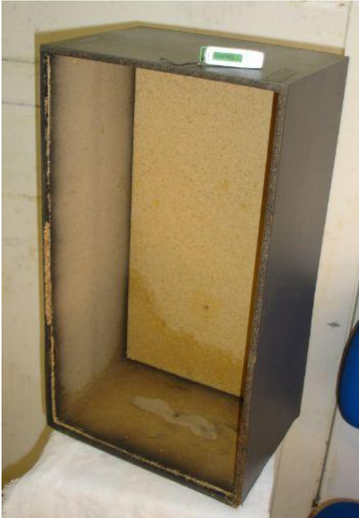
Figura 18 - Foto da caixa acústica, que teve a tampa retirada para poder cobrir o experimento.
