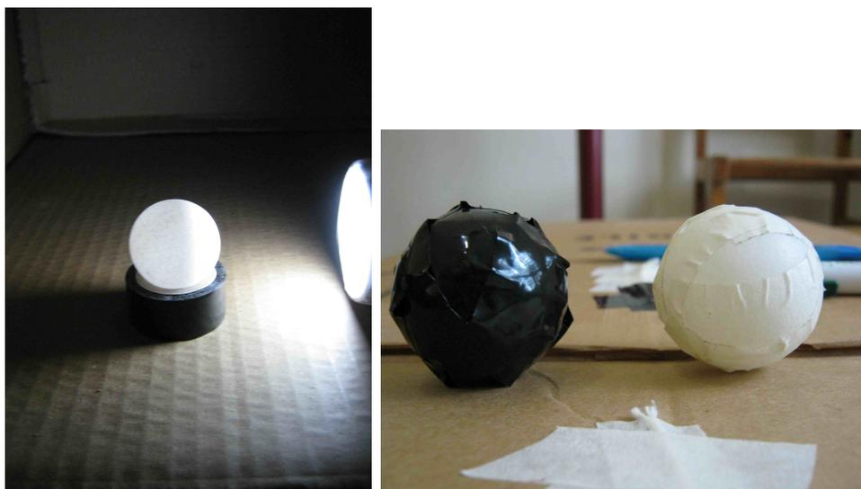
Figura 3.3: À esquerda: bola de ping pong iluminada pela lanterna, permitindo a transmissão da luz incidente. À direita: bola de ping pong revestida com fita crepe, e outra com fita isolante.
