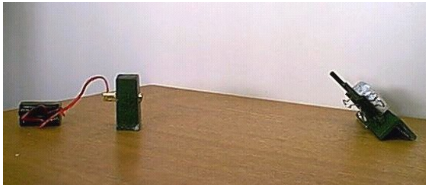
Figura 7 – Montagem holográfica utilizando laser de diodo (técnica Denisyuk)
