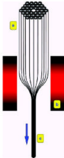
Figura 2: a) Uma pilha de tubos de vidros é construída da maneira desejada (preforma). c) Então estes tubos são fundidos e puxados na forma de fibras. b) Para amolecer o vidro é utilizado um forno entre 1000 e 2000 °C.
